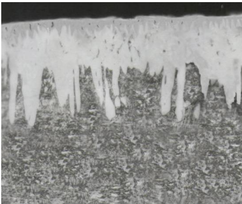
Рисунок 16 – Микроструктура зоны боридного слоя на стали 30 при скорости движения расплава электролита 0,26 м/с ( \times 500 )
