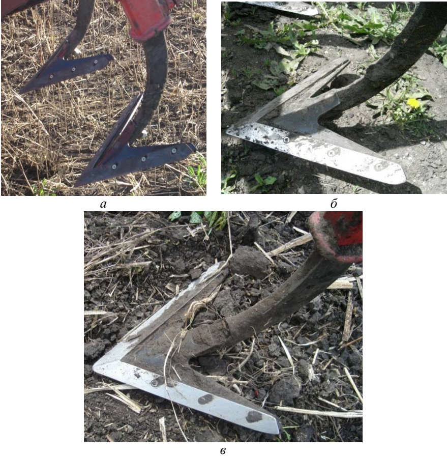
Рисунок 23 – Контроль стрельчатых лап культиватора: а – начало испытаний; б – после наработки 15 га; в – после наработки 30 га
